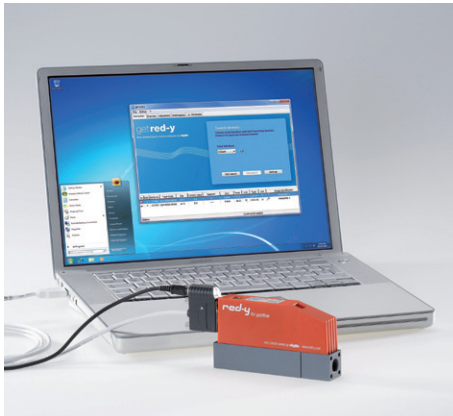
Abb.1 Die Software get red-y 5 kommuniziert über ein USB- Kabel mit einem red-y smart Massedurchflussregler
